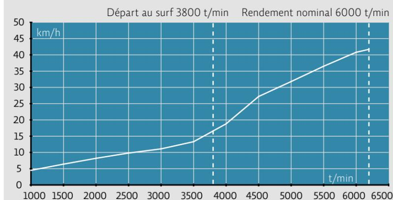
Point mort: 750 t/min, vitesse max.: 41,7 km/h à 6200 t/min. Mesuré sur le lac de Morat avec le GPS, 2 personnes à bord, pas de vent, pratiquement pas de vagues.
