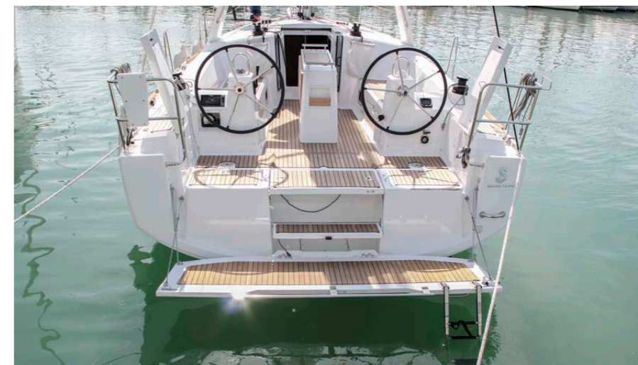
_La plateforme de bain est en option, mais a un effet déterminant sur l'Océanis 35. Elle est simplement actionnée à la main au moyen de l'échelle de bain.
