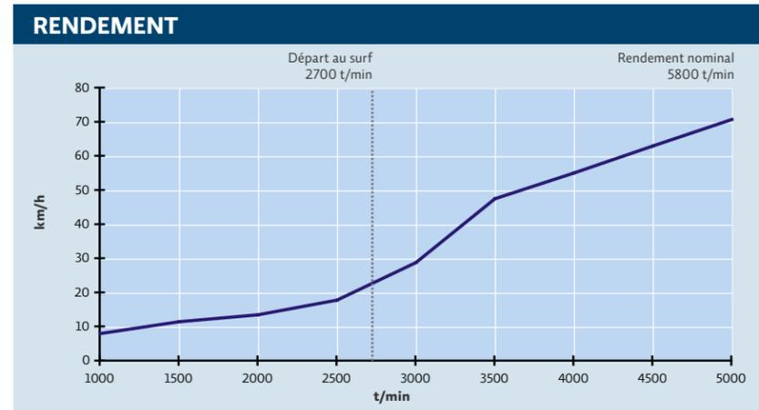
Point mort: 550 t/min, vitesse maximale: 75 km/h à 5250 t/min. Mesurée avec le GPS, 2 personnes à bord, pas de vent, plan d'eau calme.
