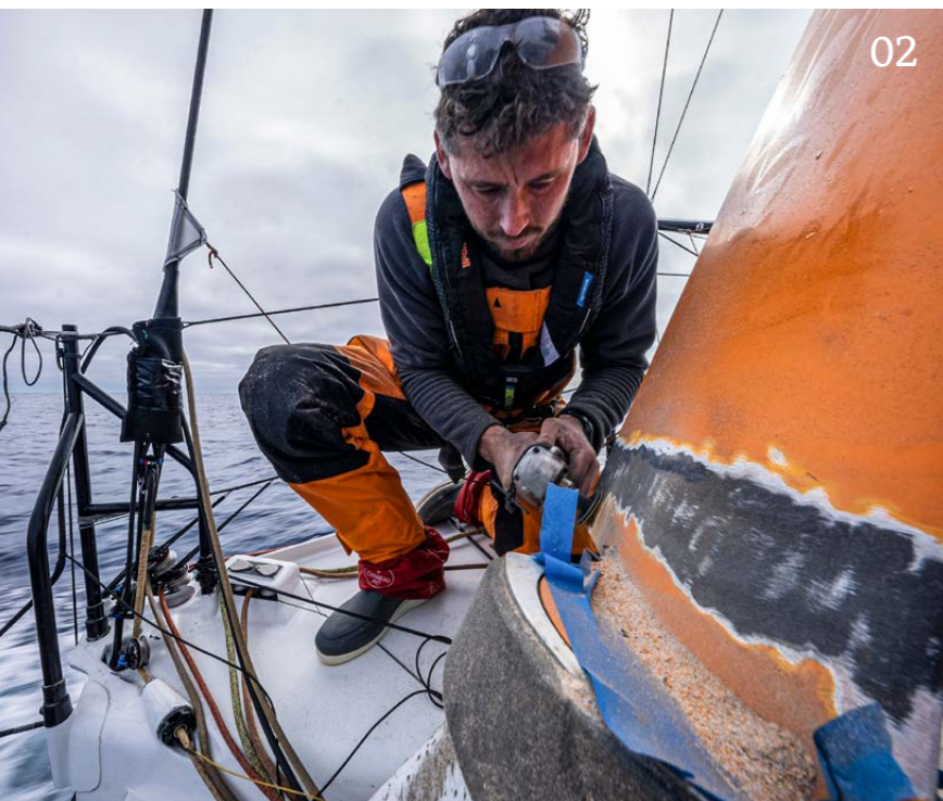
01 La fissure en tête de mât du Malizia a pu être réparée en haute mer. Pour ce faire, Will Harris et Rosalin Kuiper ont passé beaucoup de temps à des hauteurs vertigineuses...
