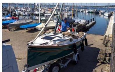
La coque est fabriquée en stratifié PRV selon le procédé d'application manuelle, avec un noyau en mousse Divinycell. Le bateau est construit en Pologne, tandis que l'aménagement est réalisé chez Swallow Yachts au Pays de Galles. Le gréement est composé d'un mât en fibre de carbone renforcé de plusieurs couches supplémentaires, ce qui permet de se passer de barre de flèches et de pataras.
