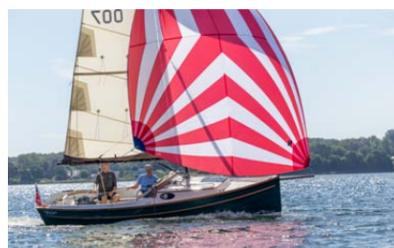
La navigation sur le BayCruiser 21 peut être vécue de différentes manières: comme un dériveur sans ballast d'eau, ou comme un petit yacht avec ballast. Le gréement simple permet un maniement facile, et les voiles génèrent rapidement la propulsion souhaitée. Sous gennaker, il est possible de déjauger et d'atteindre des vitesses à deux chiffres même par forte brise.
