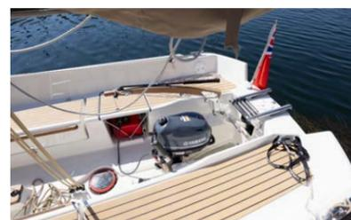
Il n'y a pas beaucoup d'options – lors de l'achat d'un BayCruiser 21, l'important est le choix du moteur. Le hors-bord est placé dans un puits qui s'étend loin dans le cockpit et qui est partiellement fermé par des lamelles en plastique lorsqu'il est relevé. En cas de houle, cette solution est bien plus pratique qu'un hors-bord fixé à la poupe. Une alternative électrique est aussi possible.
