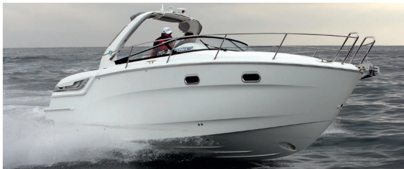
Leerlauf: 650 U/min, Höchstgeschwindigkeit: 37,9 km/h bei 5050 U/min. Gemessen mit GPS, 2 Person an Bord, etwa 10 Knoten Wind, bewegtes Wasser.
