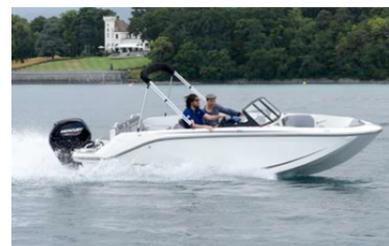
Die Struktur des Rumpfes erinnert an einen Trimaran: Zwei sanft zum Bug hin ansteigende, schmale und asymmetrische «Aussenrumpfe» flankieren beidseitig den V-förmigen Mittelteil, was eine insgesamt verblüffend hohe Fahrstabilität in allen Lagen, ob Geradeausfahrt oder in engen Kurven ermöglicht – und zwar auch bei der respektablen Höchstgeschwindigkeit von gut 60 km/h.
