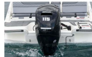
Laut Hersteller gelten 115 PS als maximale Antriebsleistung – entsprechend war auch das Testboot ausgerüstet: mit einem Mercury F 115 PS EFI. Möglich sind auch 100 PS, was den Fahrspass wohl nicht substantiell mindern würde. Jedenfalls wenn die Zulassung von maximal acht Personen nicht ausgelastet wird. Die ebenfalls noch angegebenen 80 PS scheinen dagegen knapp.
